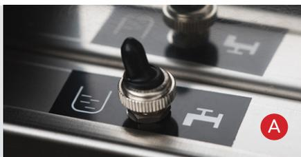
6. En ce qui concerne la machine Evoluzione, veuillez vous reporter à la Fig. A. Retirez le réservoir d'eau de la machine, déplacez le commutateur de la position d'icône du réservoir d'eau vers la position d'icône du robinet d'eau. Dans le cas de la R 58 ou de la R 60V, veuillez vous reporter à la section « Programmation de votre R 58 / R 60V ».
