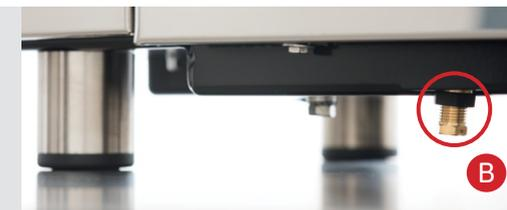
9. Dans le cas où la pression de la pompe nécessiterait un réglage, celle-ci est réglable de l'extérieur à partir du dessous de la machine (Fig. B). Avec soin et à l'aide d'une douille de 14 mm, desserrez la bague de réglage de la pression de la pompe.
