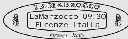
L'afficheur numérique est un écran rétroéclairé capable d'aligner 2 lignes de 16 caractères. L'afficheur permet à l'opérateur d'interagir avec la machine espresso pour changer visiblement les valeurs des paramètres. L'afficheur fournit également des informations importantes à l'opérateur.
