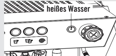
Anhand des feststehenden Rohrs (Pos. 9 in Abb. 1) kann heißes Wasser abgegeben werden. Zur Abgabe von heißem Wasser die Tee-Taste drücken, die sich zwischen der letzten Brühgruppe rechts und dem Dampfrohr befindet.
