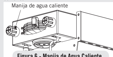
Figura 6 - Manija de Agua Caliente
