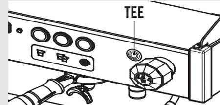
Anhand des feststehenden Rohrs (Pos. 9 in Abb. 1) kann heißes Wasser abgegeben werden. Zur Abgabe von heißem Wasser die Tee-Taste drücken, die sich zwischen der letzten Brühgruppe rechts und dem Dampfrohr befindet.
