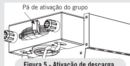
Figura 5 - Ativação de descarga
